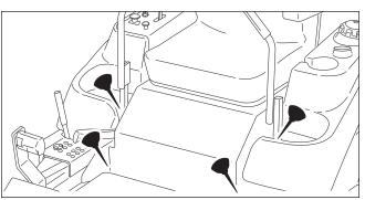
Figure 19. Control Handle Pivots & Seat Plate Pivots
